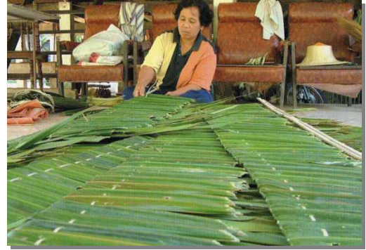
เย็บจากมุงหลังคาบ้าน
